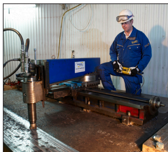
Efter att ny 80 millimeters topplåt svetsats dit planfrästes den inom +/- 0.05 mm.
