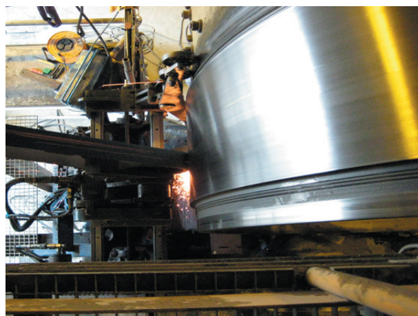
Ytan efter avslutad slipning.
